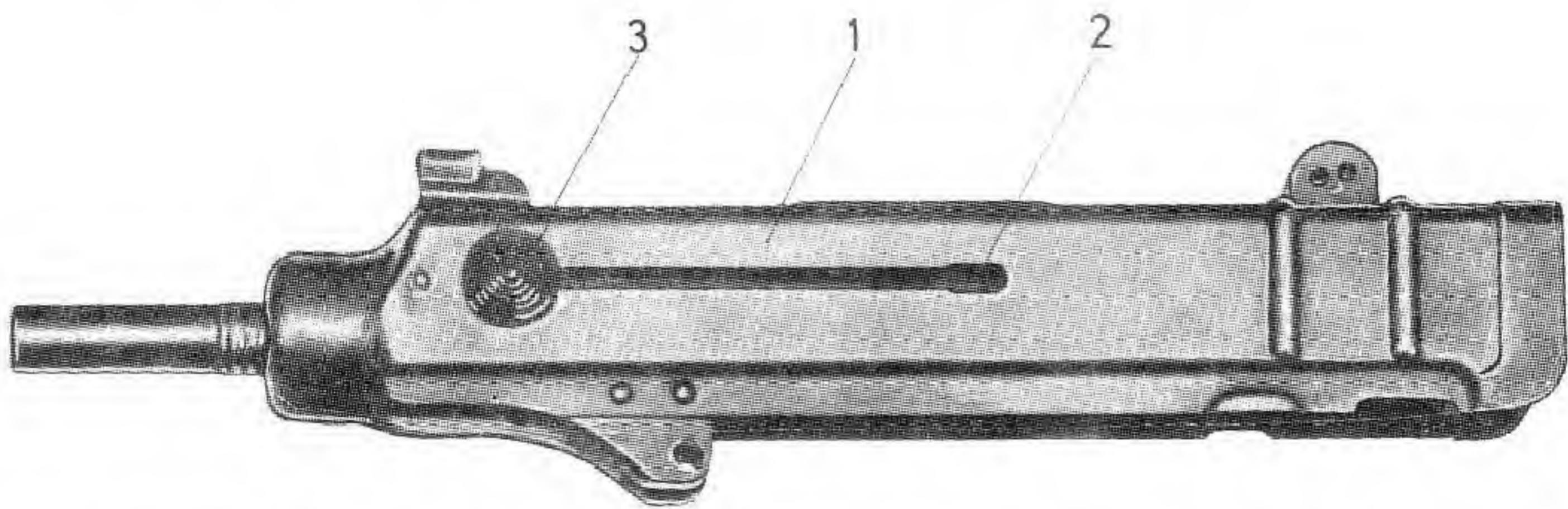
Sl. 26 – **Vodica zatvarača sa zatvaraćem i opružnim povratnikom (sklop):**
